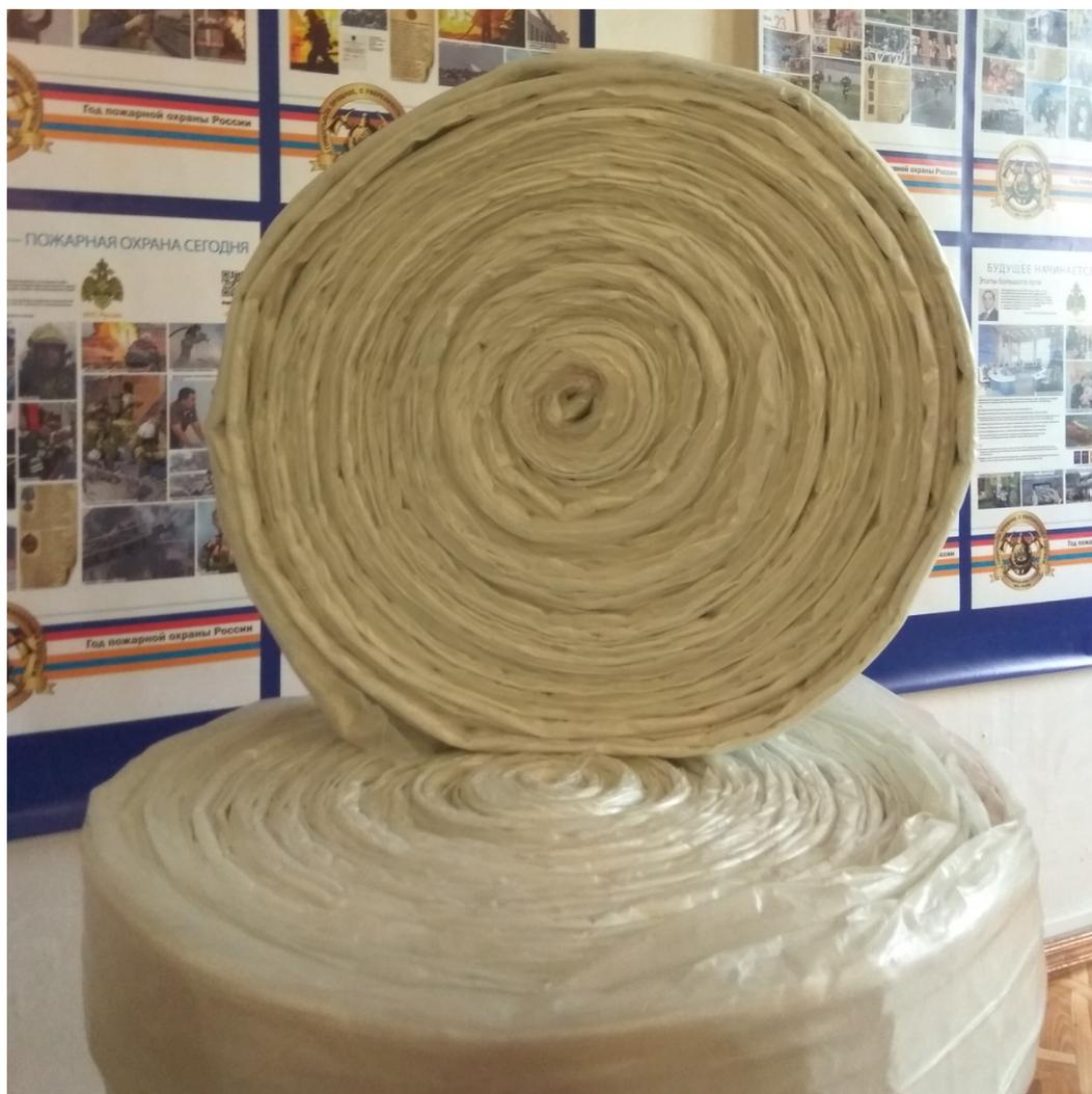
**Рукав защитный для дымовых труб, отводящих топочные газы от теплогенерирующих аппаратов, работающих на газообразном топливе и вентиляционных каналов (далее – рукав защитный), изготавливается и поставляется в виде многослойной композитной замкнутой оболочки, состоящей из упаковочного, двух рабочих и одного монтажного слоя.**
